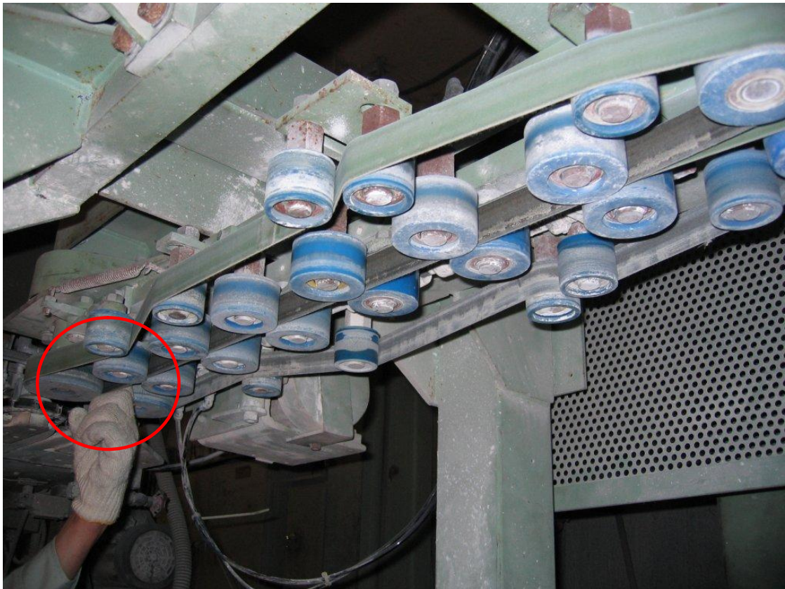
このようにベルトを引き下げようとして、ベルトとローラーに挟まれた
