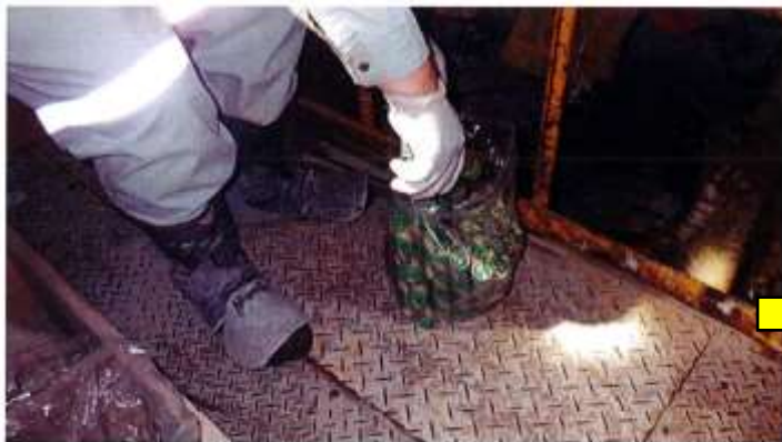
対策前 段ボールから出した爆薬の状態 (ビニール袋に入った状態)
