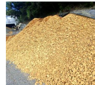
坑廃水の処理工程で発生する「中和殿物」
