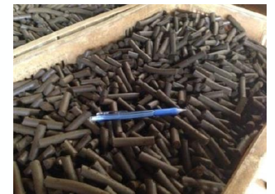
製造直後の脱硫化水素剤
