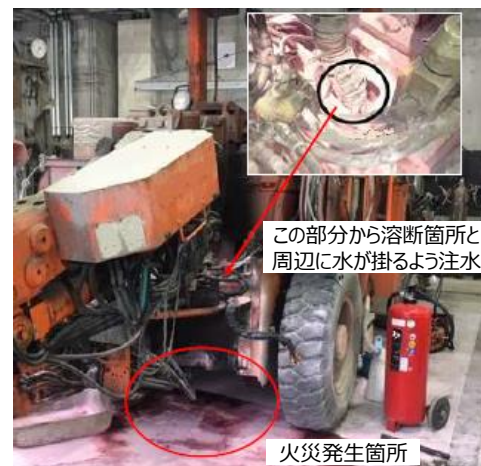
溶断作業中に水と間違えて灯油を掛け出火（令和2年10月）
